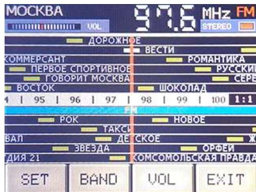
**Кнопка SET используется для вызова дополнительных кнопок.
