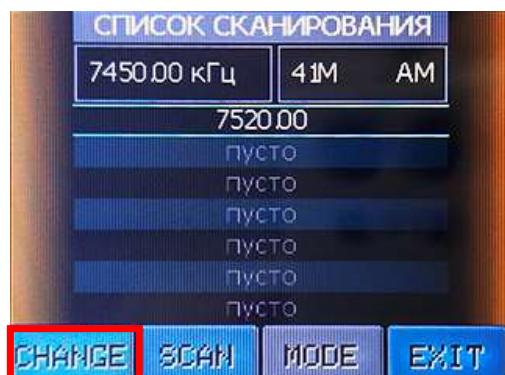
**! Кнопка CHANGE используется для вызова дополнительных кнопок.**
