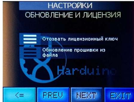
**Экраны конфигурации, доступные по кнопке **SETUP****
