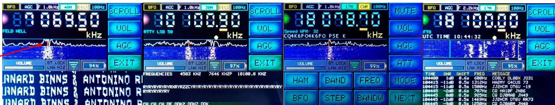
Экран декодирования цифрового режима FELD-HELL («Минифакс»). Для смещения изображения по вертикали, нажмите SCROLL и вращайте энкодер. Нажмите EXIT для выхода из режима декодирования.
