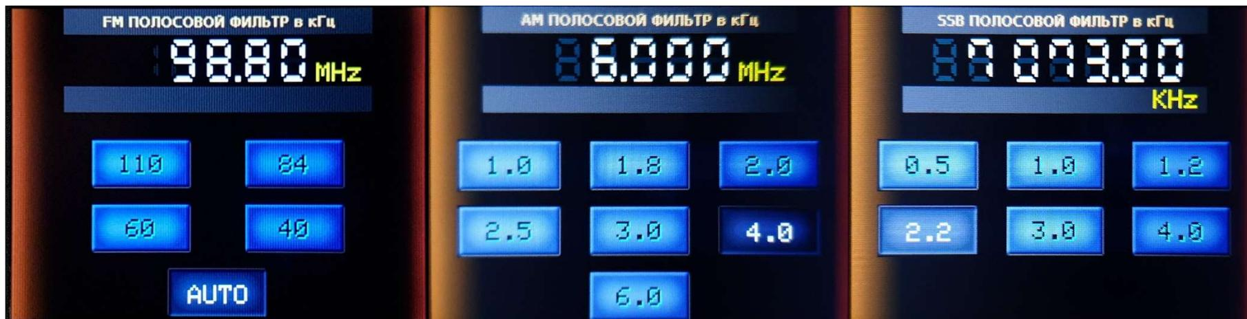
Экраны для выбора используемой полосы пропускания (полосовой фильтр) для FM – AM – SSB с индикацией текущего фильтра.
