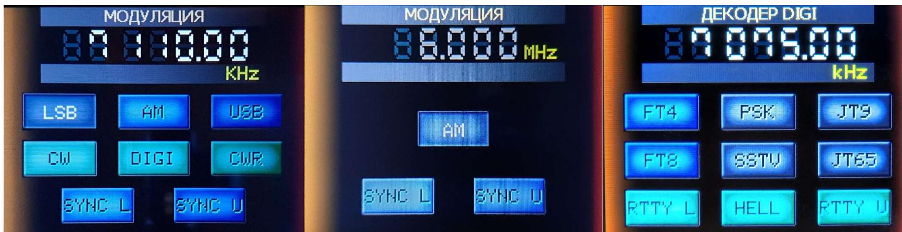
Экран для выбора видов модуляции, используемых только для радилюбительских диапазонов.
