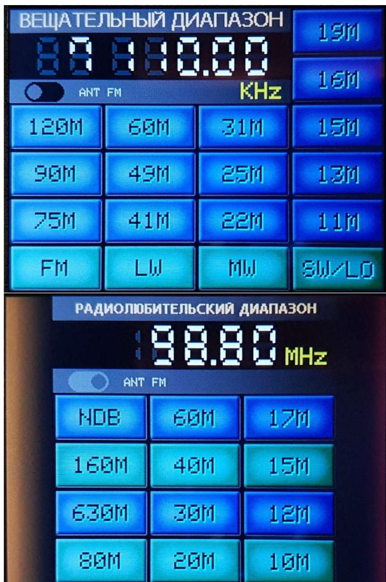
Экран для выбора диапазона вещания, с индикацией в верхней части используемой в данный момент частоты.
